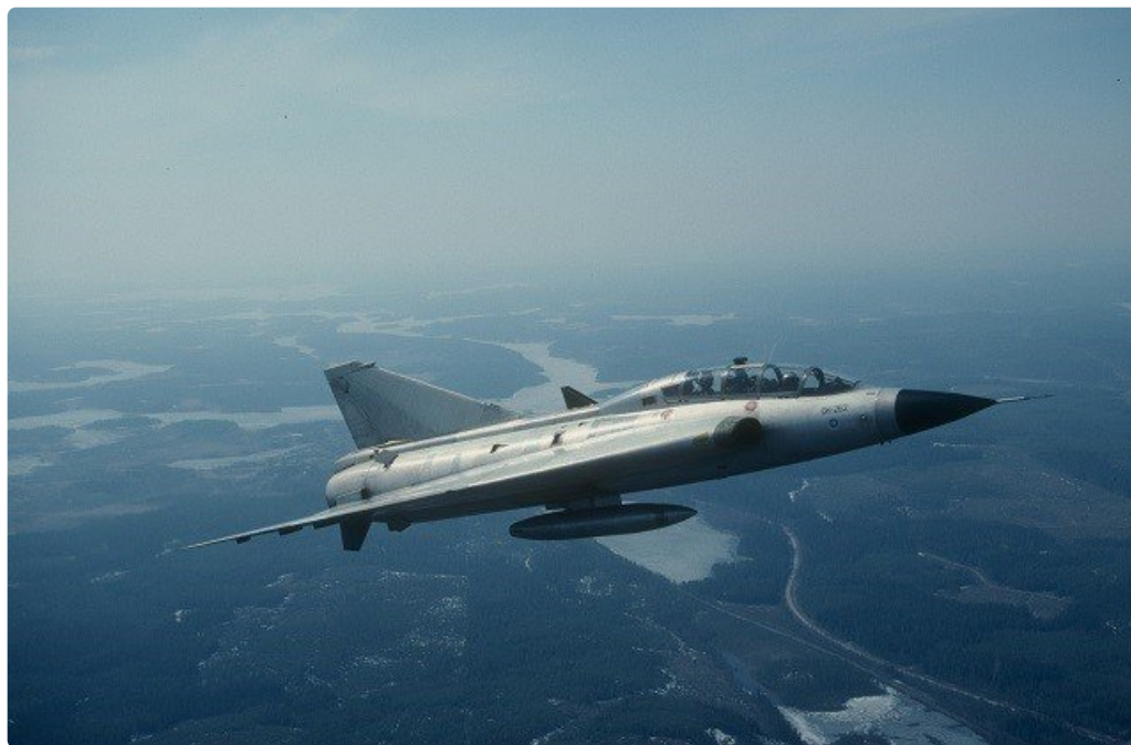
Suomen ilmavoimien kaksipaikkainen harjoitushävittäjä Saab 35CS Draken ilmassa huhtikuussa 1999. Saab 35CS Draken on Saab 35A Draken -hävittäjän aseistamaton kaksipaikkainen koulukone. Jyrki Laukkanen / Suomen Ilmailumuseo.
